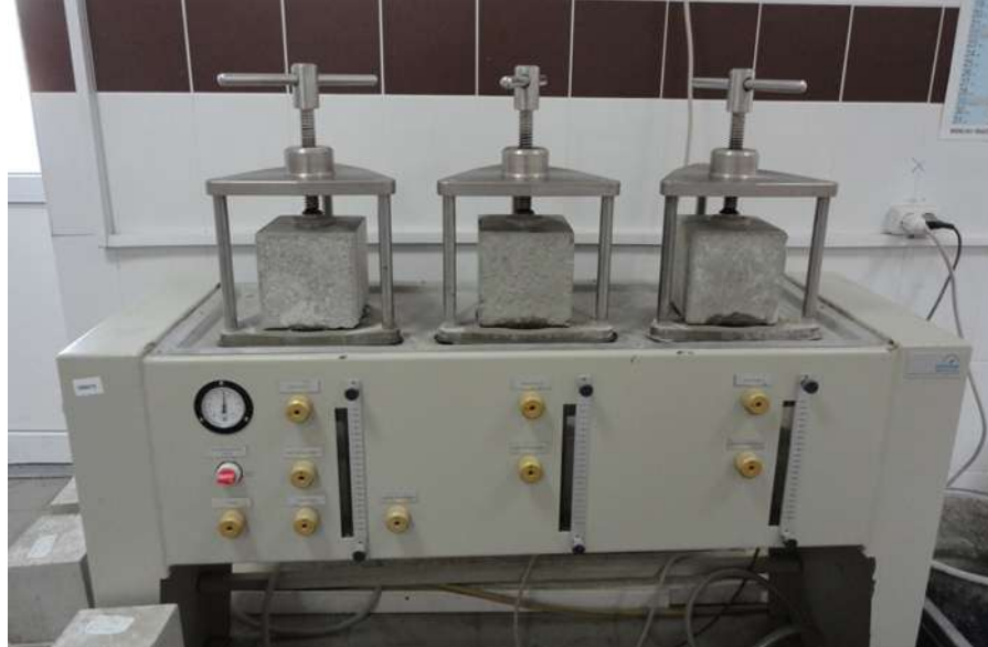
Визначення водонепроникності (EN 12390-8)
