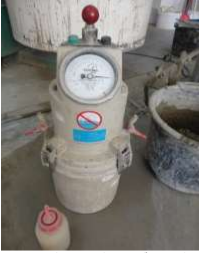
Визначення вмісту повітря у бетонній суміші (ДСТУ Б В.2.7-114-2002, EN 12350-7)
