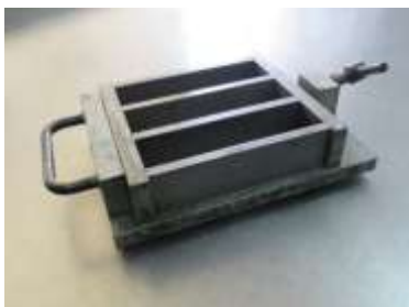
Форма для зразків-призм 40 мм × 40 мм × 160 мм
