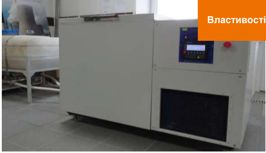
Автоматична камера для визначення морозостійкості (ДСТУ Б В.2.7-47(48,49)-96, DIN EN 12390-9)
