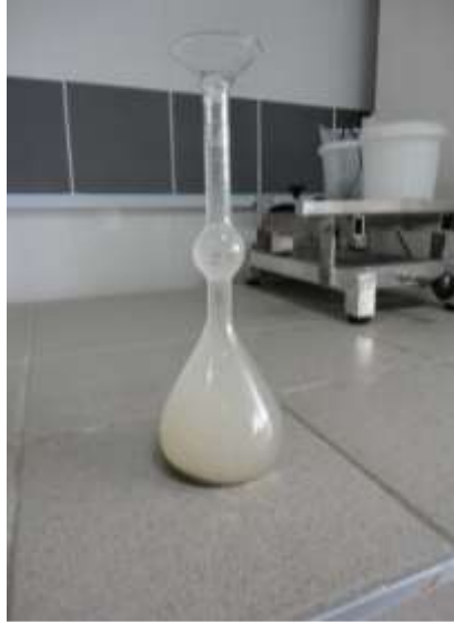
Прилад Ле-Шательє для визначення істинної густини піску
