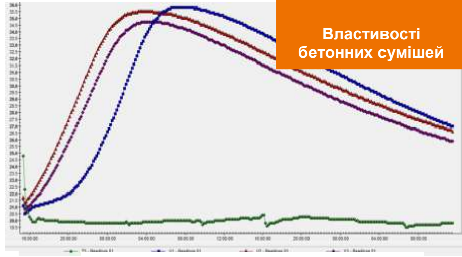
Вимірювання теплоти гідратації бетону в часі
